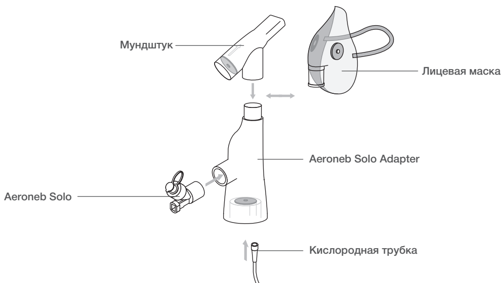
Рисунок 10. Сборка адаптера Aeroneb Solo Adapter
